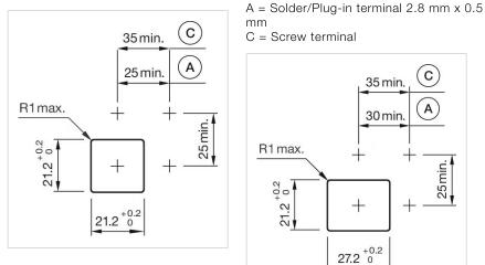
C = Screw terminal С 35 min. А 30 min.
