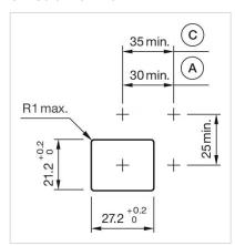
$\begin{array}{l} \mathsf{A} = \text{Solder/Plug-in terminal 2.8 mm x 0.5} \\ \mathsf{mm} \\ \mathsf{C} = \text{Screw terminal} \end{array}$
